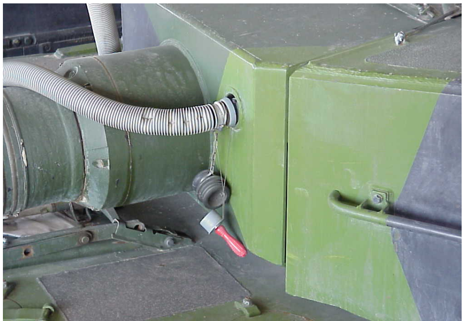
Bild 85. Lock som placeras i slangens när inte ett objekt är anslutet till avfuktaren
