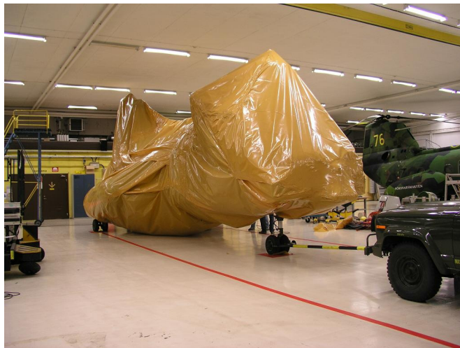
Bild 29. Helikopter täckt med plast med ångfasinhibitorer.
