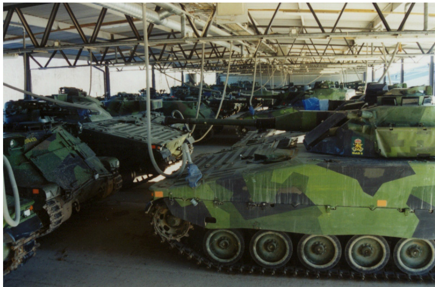
Bild 64. Öppet system med 120 anslutningsslangar
