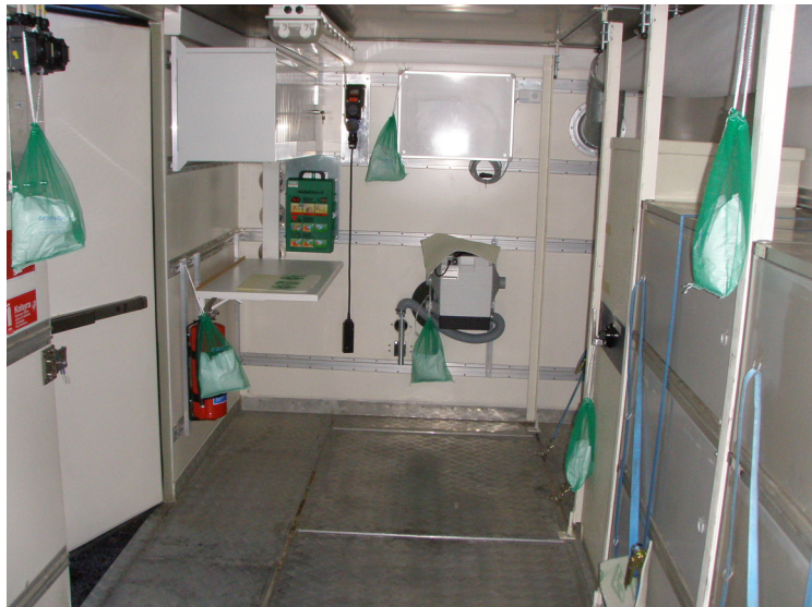
Bild 28. Container med statisk avfuktning.
