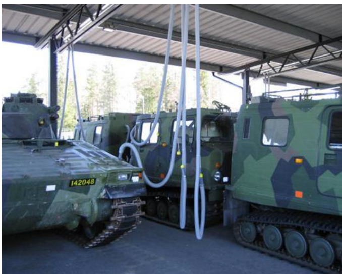
Bild 66. Avfuktat fordon under skärmtak
