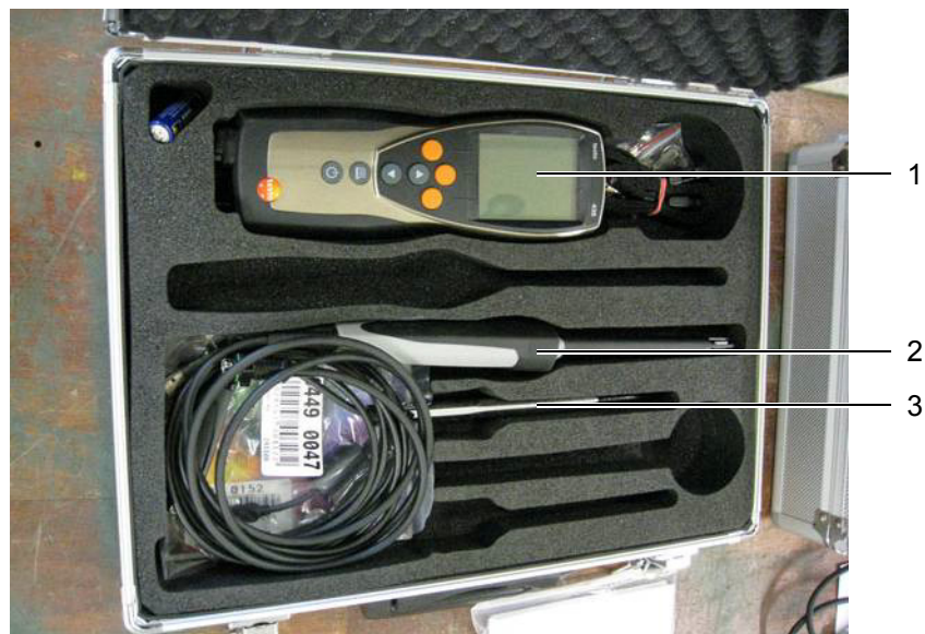
Bild 37. Multi-instrument för temperatur, fukt och tryck
