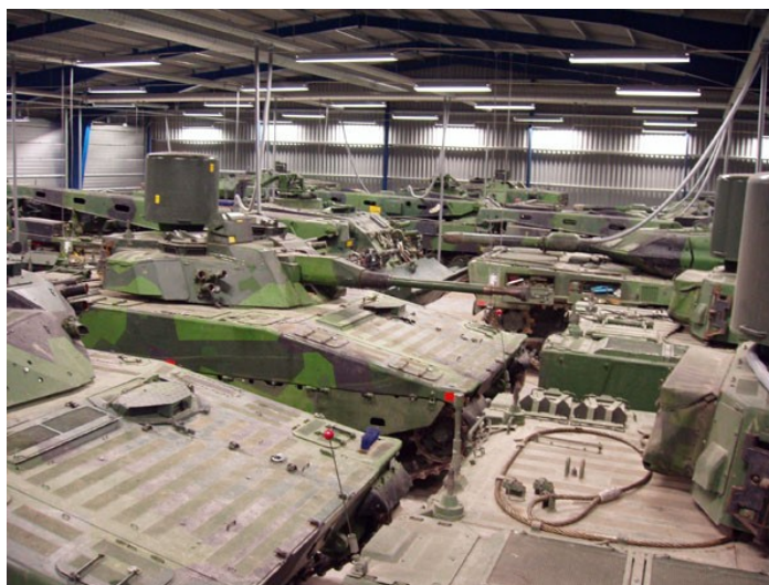
Bild 21. Helavfuktat förråd med objektvis avfuktning.
